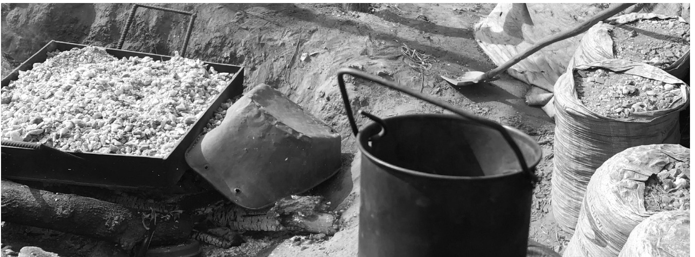
Figura 17: Copo onde a amálgama é colocada e aquecida para vaporizar o mercúrio (queima aberta)
