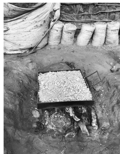
Figura 9: Local de MAPEO onde o processamento, a concentração, a amalgamação e a queima (acima) e o aquecimento do minério triturado antes da moagem (abaixo) ocorrem
