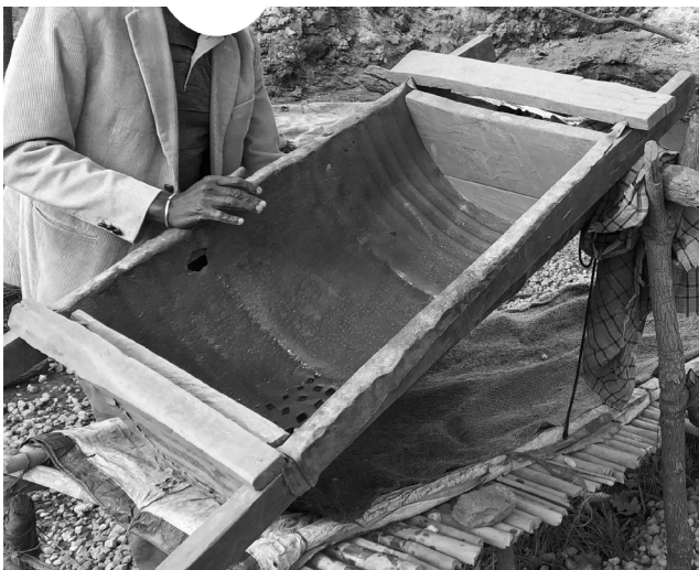
Figura 11: Ferramentas para concentração e retenção de ouro em malha de rede
